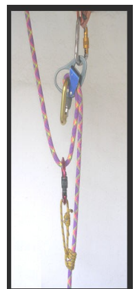
Polipasto realizado con un reverso y un nudo prusik
